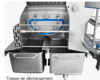
Trappe de déchargement
