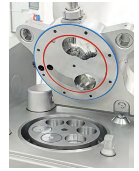
KK500 ET KK500-DV, pistons rotatifs
