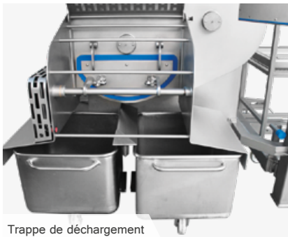
Trappe de déchargement
