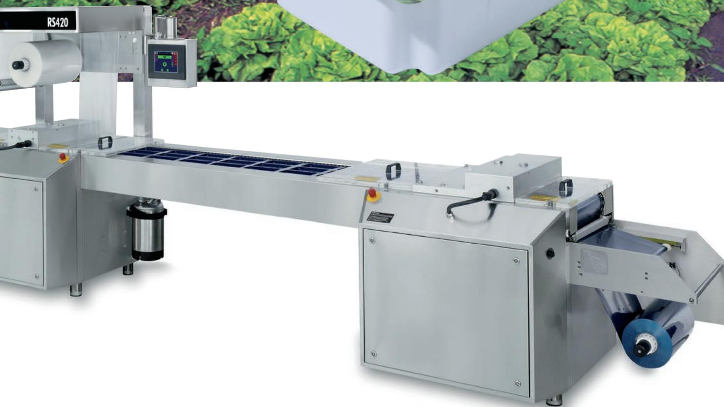
La conception de la thermoformeuse VC999 RS met l'accent sur la fonctionnalité. La machine ne comporte aucun coin ou bord saillant où la saleté pourrait s'accumuler. La structure en acier chrome-nickel permet un nettoyage rapide et aisé et répond aux prescriptions d'hygiène les plus strictes.
